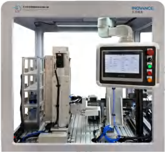
图 4 工站三：检测分拣工站内部展示
